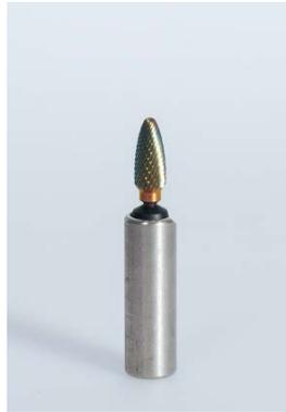
Stellen Sie die Prüflehre aufrecht hin und legen Sie eine Abtropfkappe ein. Schieben Sie dann den Fräser bis zum Anschlag in die Prüflehre. Die Abtropfkappe hat nun genau die richtige Position zur Verwendung in Ihrem GERLACH Fußpflegegerät.
