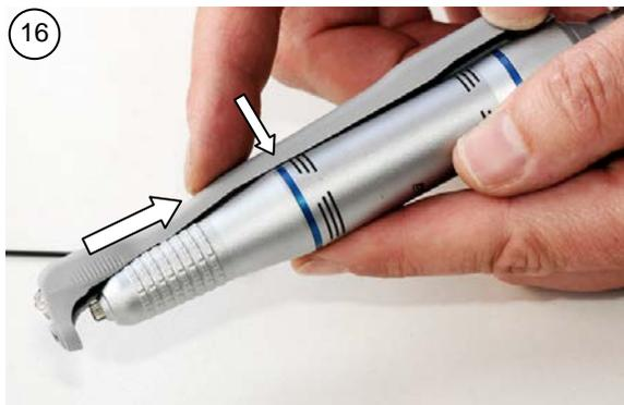
Schieben Sie den Spraykanal auf die Handstückspitze und drücken Sie dann den Spraykanal mittig auf den Halteclip.
