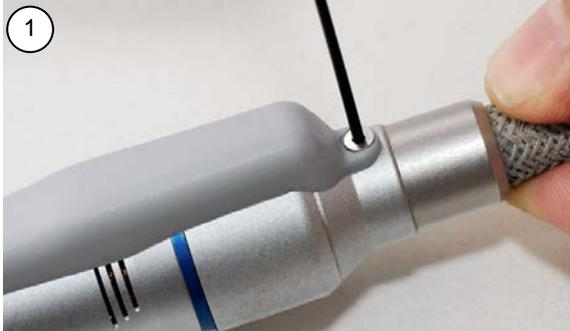
Lösen Sie die Befestigungsschraube des Spraykanals. Ein passender Innensechskantschlüssel befindet sich im Zubehör Ihres Fußpflegegerätes.
