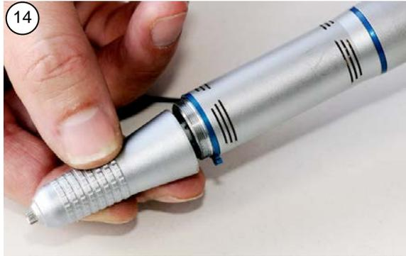
Überprüfen Sie, dass sich die Kupplung auf der Motorwelle befindet (siehe Schritt 3) und schrauben Sie dann die Handstückspitze auf den Motor.
