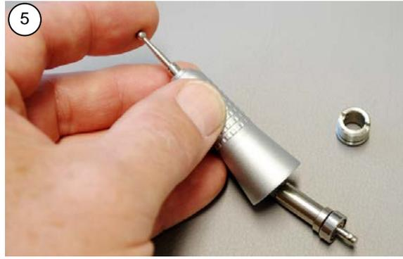
5 Entnehmen Sie die Spannkammer. Falls die Spannkammer nicht von allein aus dem Gehäuse gleitet, stecken Sie einen Prüfstift in das Handstück und schieben Sie damit die Spannkammer heraus.
