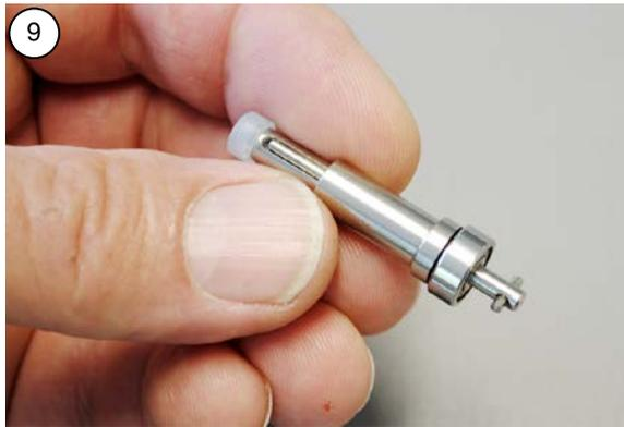
Bauen Sie die gereinigten und getrockneten Teile nun wieder zusammen. Stecken Sie zuerst die Spannbuchse (a) auf die dafür vorgesehenen Zapfen am Spannbett (b). Legen Sie nun die drei Spannstifte (c) ein und schieben die Teile gemeinsam in die Spannkammer (f).
