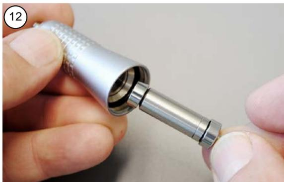
Schieben Sie nun die Welle mit der Spannkammer in das Handstückgehäuse.
