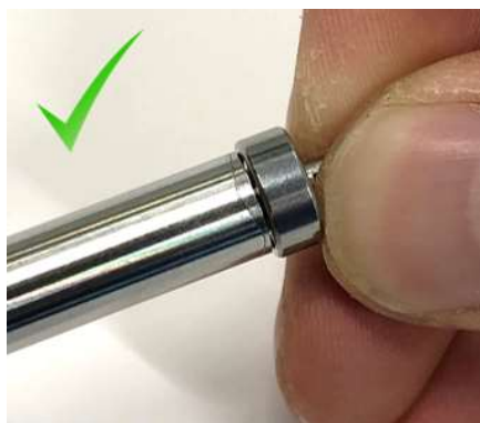
Schritt 13: Beachten Sie den korrekten Sitz der Wellen zueinander. Die Wellen müssen in sich geschlossen sein.
