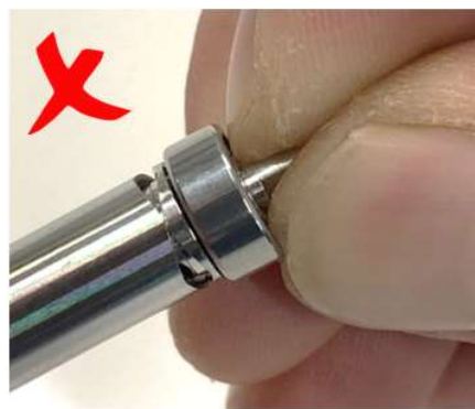
Schritt 14: Sind die Wellen nicht in sich geschlossen, führt dieses zu einer Erwärmung des Handstücks.
