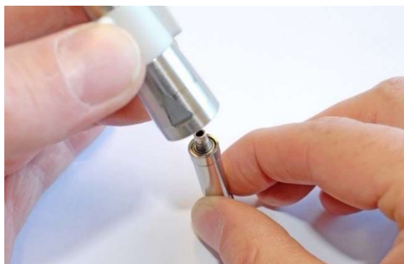
Schritt 15: Schieben Sie nun die Welle mit der Spannkammer in das Handstückgehäuse.
