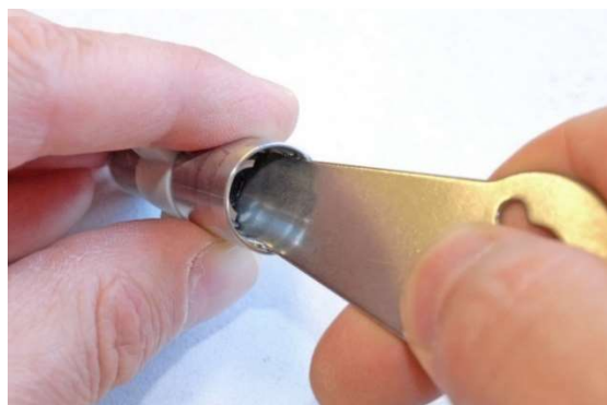
Schritt 16: Die Verschlussmutter wird nun eingesteckt und mit dem Reinigungsschlüssel handfest eingedreht.
