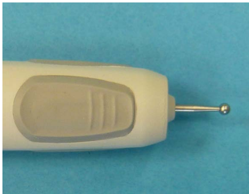
Kein Farbring sichtbar - Spannvorrichtung ist in Ordnung und keine Gefährdung vorhanden.
