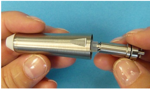
Schritt 6: Die montierte Spannkammer wird in die im Handstückgehäuse verbliebene Welle geschoben.
