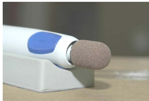
Fräserdurchmesser 16 mm. Saugöffnung fast vollständig verdeckt.
