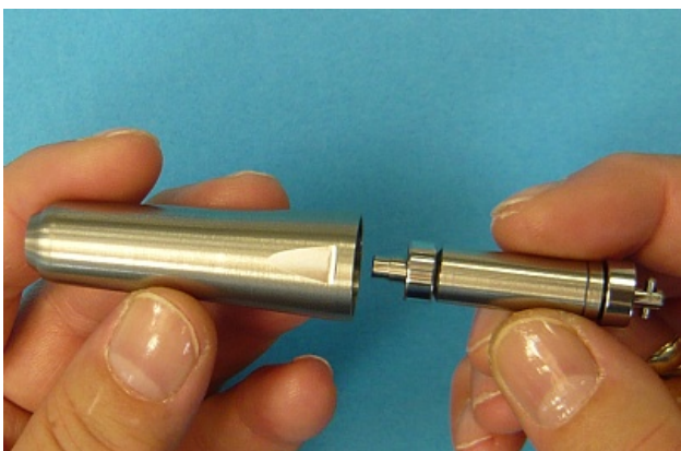
Schritt 3: Beim wieder Montieren wird die Spannkammer in die Welle geschoben und in das Handstückgehäuse eingeführt. Die Verschlussmutter wird eingesteckt und fest angezogen.
