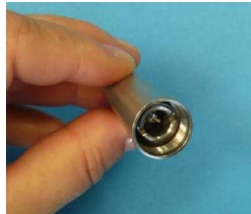
Schritt 7: Die Verschlussmutter wird nun eingesteckt und mit dem Reinigungsschlüssel handfest eingedreht.
