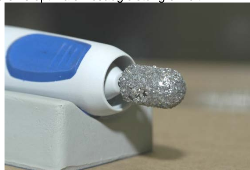
Fräserdurchmesser 10 mm – freie Saugöffnung
