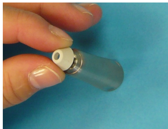
Schritt 4: Dann wird die Staubkappe wieder aufgesteckt.
